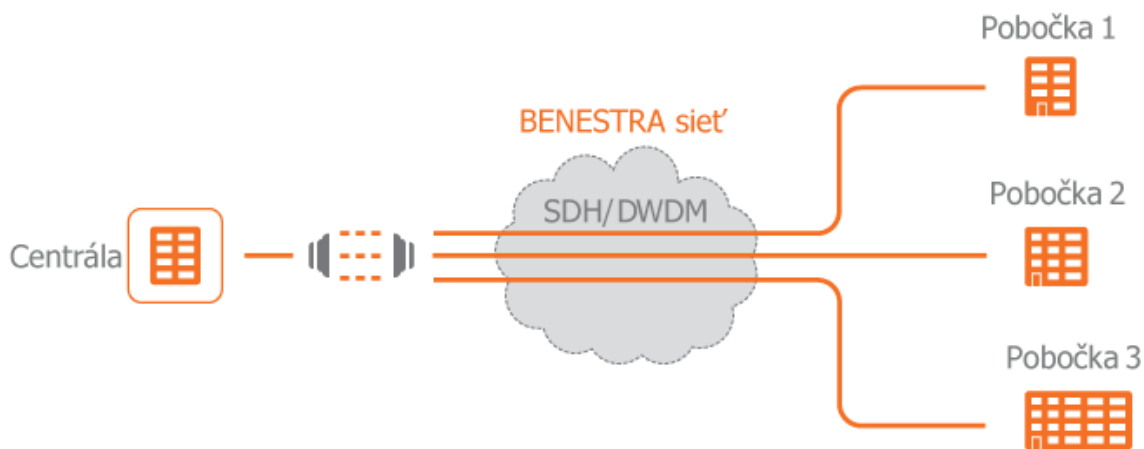
Obrázok č. 3 – Príklad hviezdicovej topológie hub-and-spoke, Benestra (produkt Leased line, riešenie hub-and-spoke)
